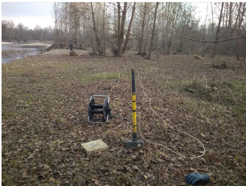
Foto 9: Particolare stendimento prova MASW – Sito di Chivasso.
